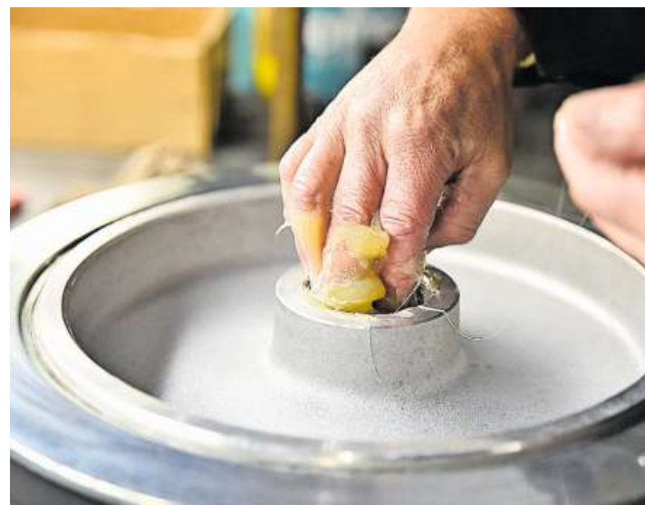
Das Lagergehäuse der Rolle bekommt eine Fettpackung.
